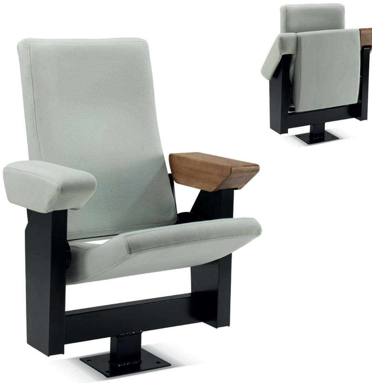
Pour s'asseoir, le spectateur actionne le système du fauteuil en abaissant l'assise. Celle-ci entraîne la montée du dos (pour avoir un grand dossier) et la mise en place des accoudoirs.
